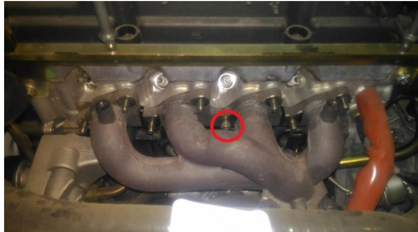
دمونتاژ پیچ های اتصال منیفولد به سرسیلندر (19-26 N.m)
