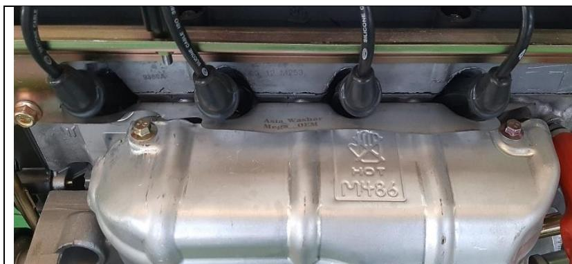
تصویر نهائی بعد از تعویض واشر و کنترل عدم
