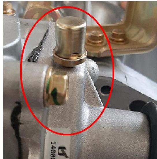
سوپاپ تخلیه هوای گیربکس
