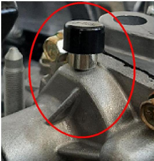
سوپاپ تخلیه هوای گیربکس
