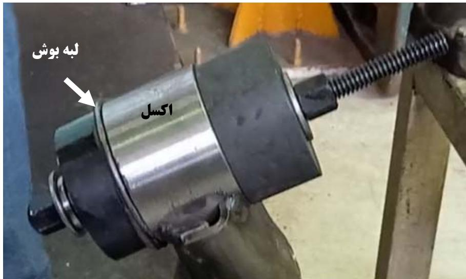
اتمام عملیات: لبه بوش کاملاً به حلقه اکسل مماس شده است
