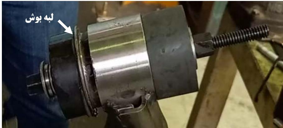
بوش به آرامی در حال قرار گرفتن در اکسل و لبه بوش در حال نزدیک شدن به حلقه است.
